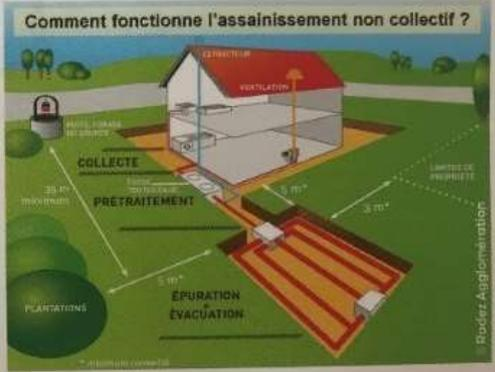
Le diagramme illustre le processus de traitement des eaux usées domestiques. Les eaux usées quittent la maison par un regard de ventilation (3 m³) et sont collectées dans un collecteur (3 m³). Elles passent ensuite par un prétraitement (3 m³) et sont évacuées dans un système d'épuration et d'évacuation (3 m³). Le système est complété par un regard de propriété (3 m³) et des plantations. Le tout est installé sur un terrain de 33 m² minimum. Le diagramme est attribué à Rousset Agglomération.
